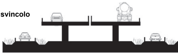
fosso, svincolo, fosso, SS308 in viadotto, fosso, svincolo, fosso
